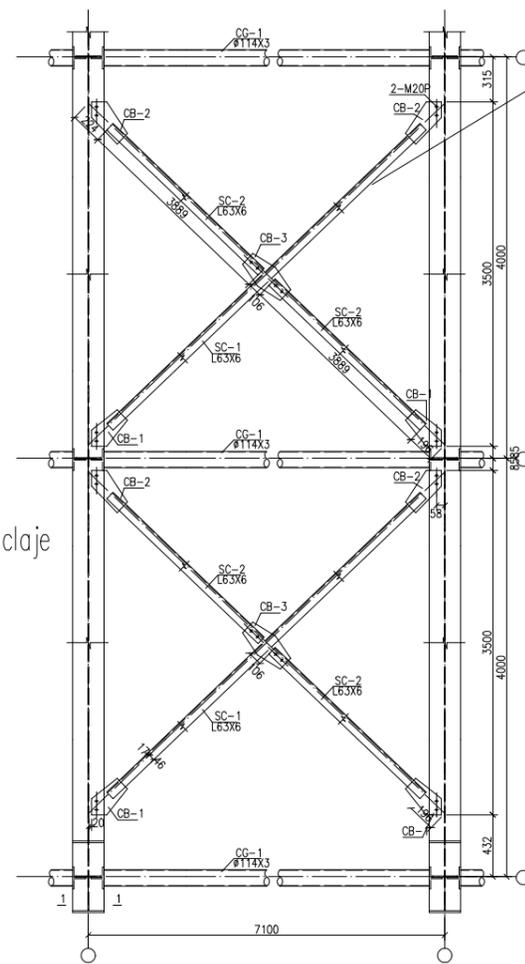
厂房屋顶支撑详图 Diagrama de soporte del techo de la planta
